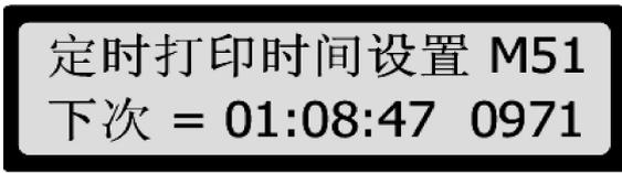
M51 窗口中“下次 = 00: 00: 00”表示下次打印的时间，“0971”则表示剩余的打印次数。
